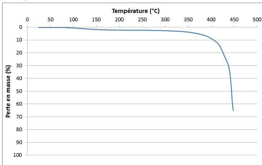
Le polyamide 6.6 commence à se dégrader à 330°C. Il est faiblement dégradé entre 100 et 330°C où il subit une perte en masse de 3 %.
