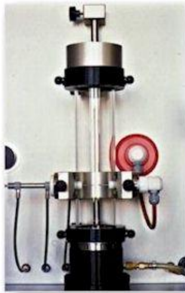
Figure 6 : Photographie du tube de Hartmann modifié dit Mike 3 (Kühner AG)
