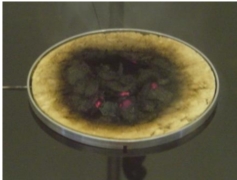
Figure 3 : Test d'inflammation en couche de 5 mm
