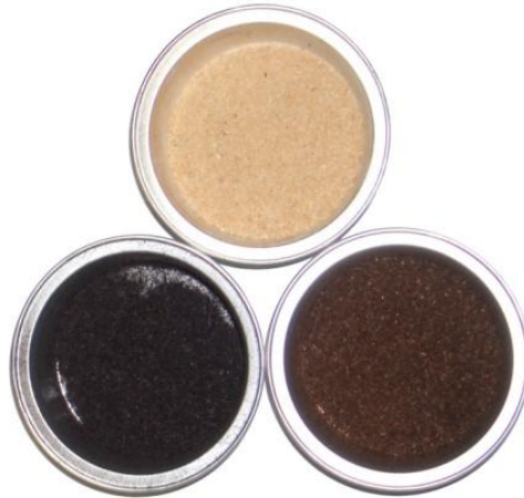
Figure 14 : Brunissement d'un échantillon de sapin : a) aspect initial, b) après stockage à 220 °C, c) après stockage à 240 °C.
