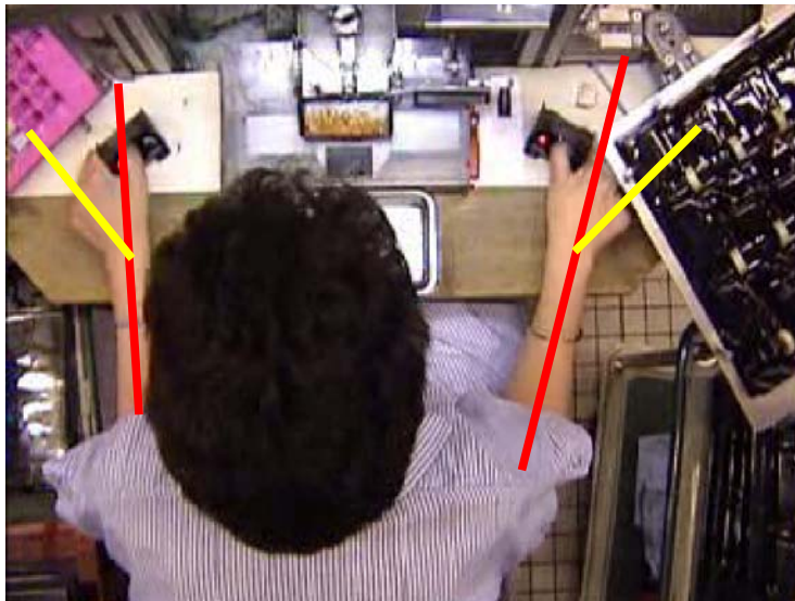
Poste vrillage diode : Déviation cubitale des poignets
