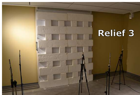
FIGURE 4.26 – Les trois différentes surfaces à relief étudiées. Relief 1 : rainures de 0,5 m de hauteur (haut) ; Relief 2 : rainures de 0,25 m de hauteur (milieu) ; Relief 3 : cavités de 0,25 \times 0,20 \text{ m}^2 (bas).
