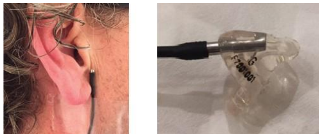
Figure 4.6 – Position des microphones pour mesurer les atténuations des PICB durant les mesures de seuils masqués. Gauche : microphone placé près de l'entrée du conduit auditif (un à chaque oreille) pour mesurer les niveaux sonores soit sous le casque soit sans PICB. Droite : microphone inséré dans un bouchon moulé via un canal supplémentaire afin de mesurer le niveau sonore après le filtre acoustique présent dans le bouchon.
