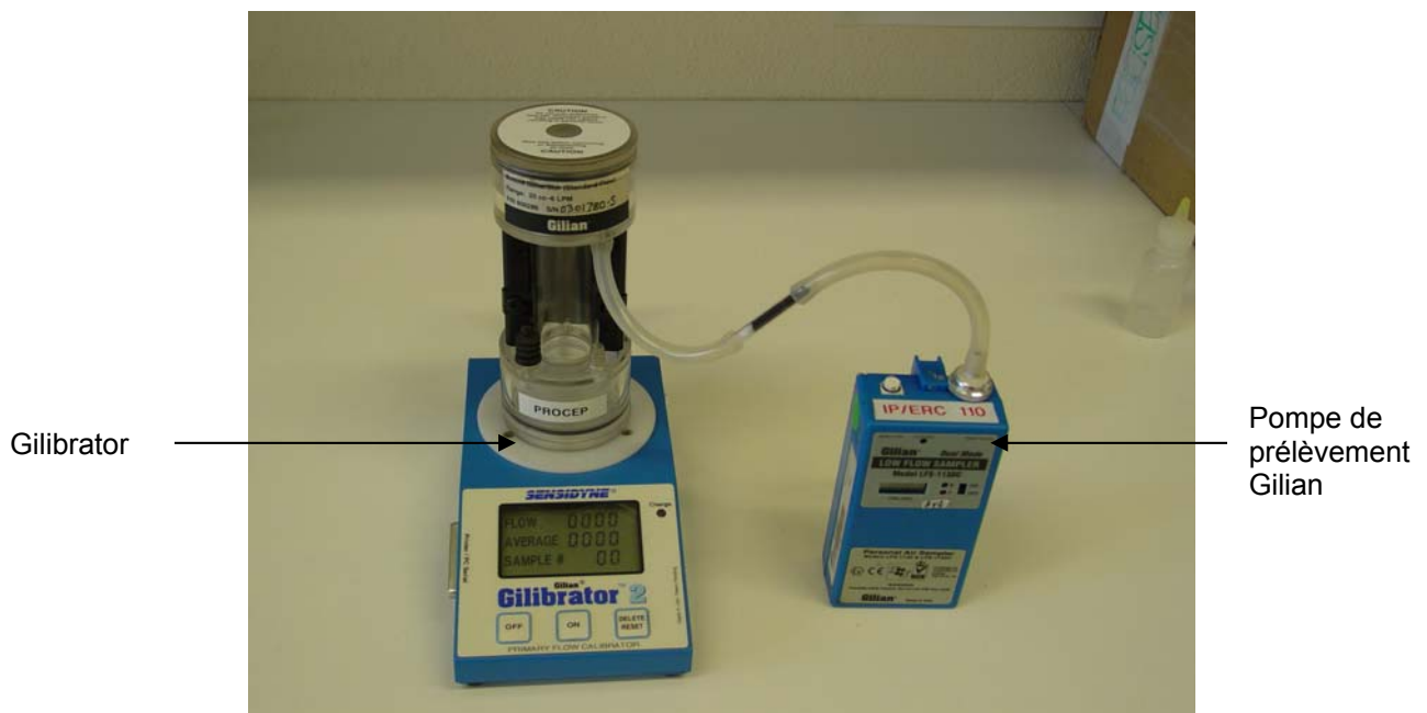
Photo 2. Calibration des pompes de prélèvement
