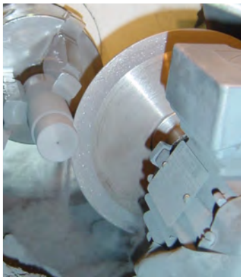
FIG. 1.1 – Tronçonnage après tournage
