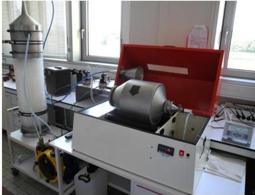
Figure 5 Tambour rotatif pour mesurer la pulvérisation des poudres. A gauche : colonne de traitement d'air en humidité relative.
