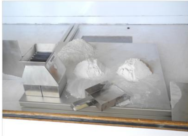
Figure A2, 3 Diviseur manuel à 12 rifles (division en 2 parts égales)
