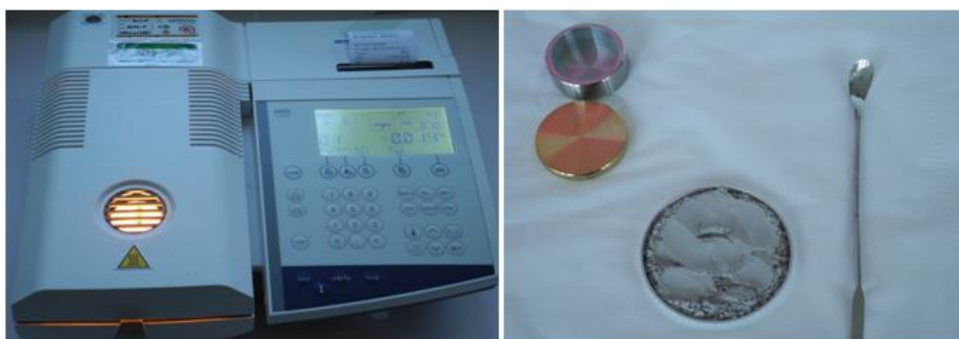
Figure 1 Thermobalance HR83-P METTLER et échantillon de poudre de 35 cm 3
