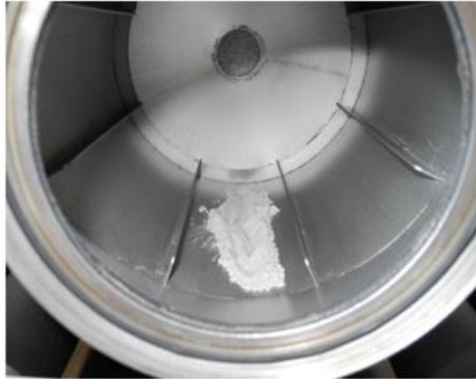
Figure 8 Intérieur du tambour rotatif équipé de pales avec un échantillon de 35 cm 3 de poudre étalé au fond
