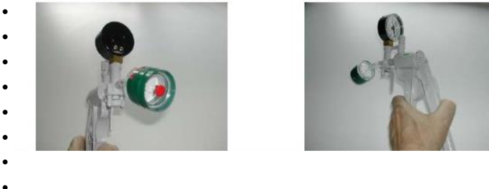
Figure 2 : pompe à vide manuelle
