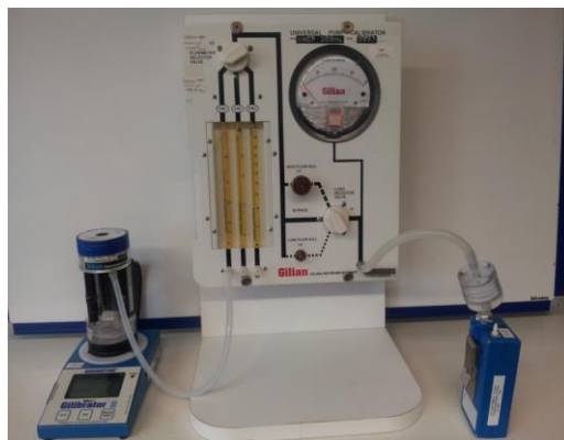
Figure 11 : montage pompe et calibreur
