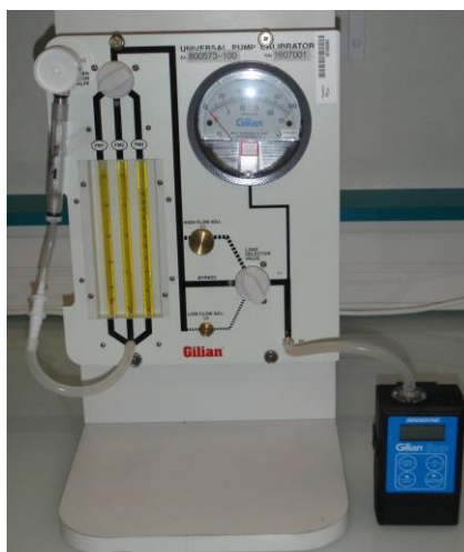
Figure 10 : montage pompe, calibreur puis dispositif
