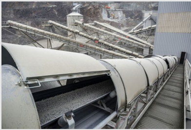
Capotage d'une bande transporteuse dans une carrière
