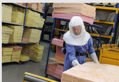
Poste de découpe des panneaux de laine de verre, avec port d'une combinaison et d'un masque à assistance respiratoire, pour l'isolation thermique de pianos de cuisine
