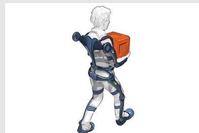
© Deledda Robot d'assistance du corps entier de type exosquelette (RAP ac)
