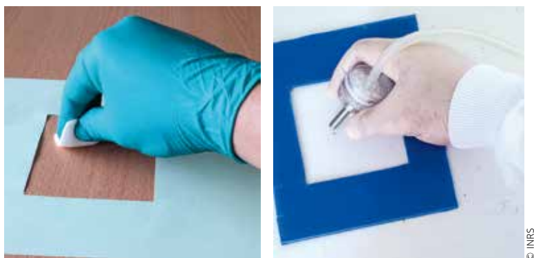
↑ FIGURE 2 Exemple de prélèvements surfaciques par essuyage et par aspiration.
