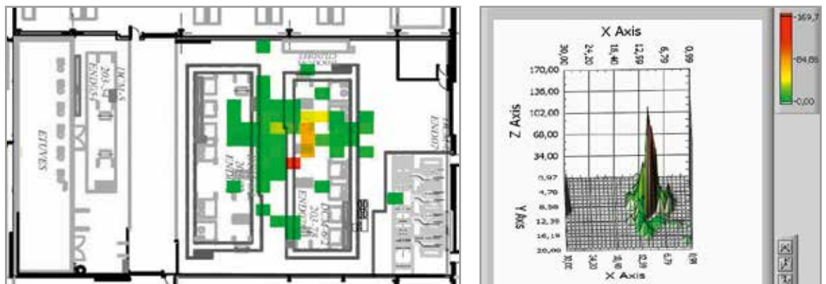
FIGURE 8 → Exemple de graphique 2D et 3D de concentration en solvant, de la concentration la plus faible (en vert) à la plus élevée (en rouge) (graphique de gauche) et son équivalent en représentation 3D (graphique de droite).
