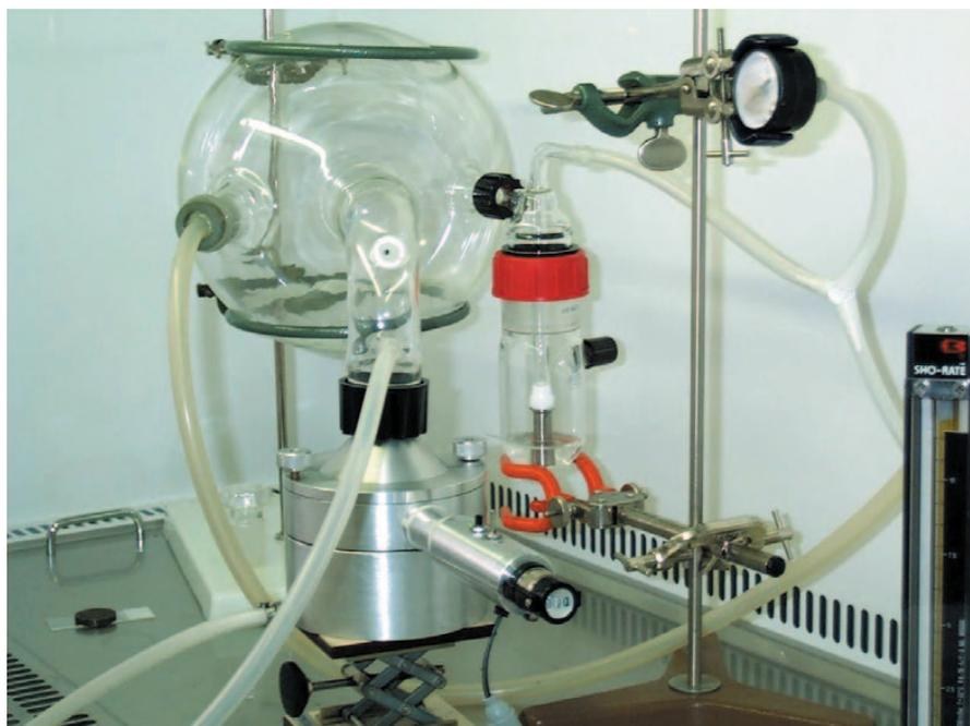
La salissure consiste en du sérum albumine bovine (BSA, société SIGMA) de concentration égale à 3,2 mg/ml. Un volume de 25 ml de cette solution est placé dans le nébuliseur avant chaque atomisation. La surface du matériau est encrassée par l'aérosol protéique pendant 2 minutes. Cette technique permet un encrassement contrôlable et reproductible des supports.
