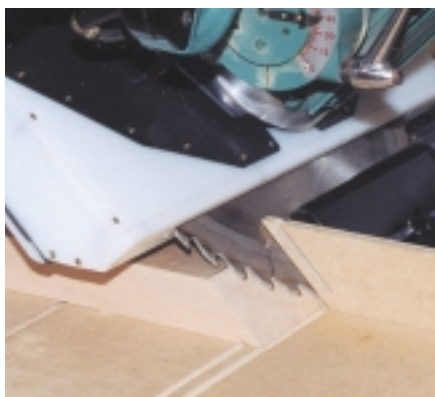
Fig. 19. Sciage incliné à 45° - 45° inclined sawing
