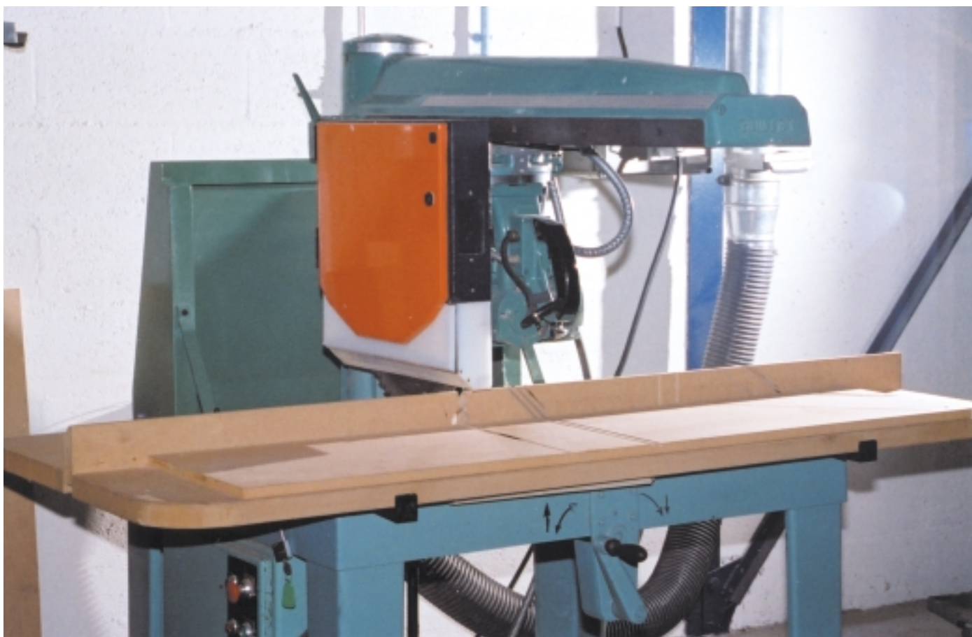
Fig. 3. Scie radiale à aménagement manuel - Radial saw with manual feed
