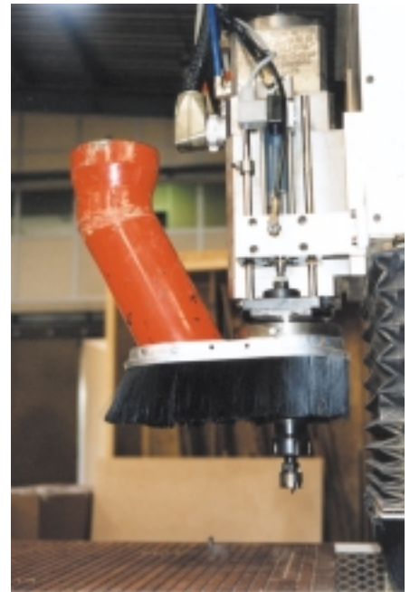
Fig. 29. Dispositif de captage existant - Existing exhaust device
