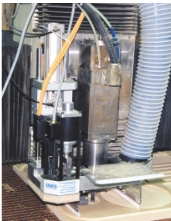
Fig. 28. Vue d'ensemble du dispositif de captage (volet en façade relevé) - Overview of the exhaust device (flap on the front panel lifted up)
