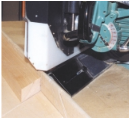
Fig. 20. Sciage à onglet à 45° - 45° mitring
