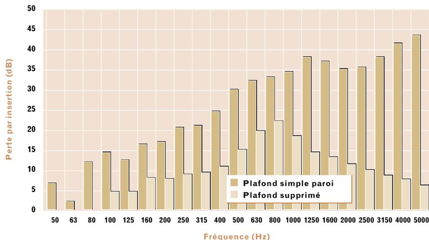
**Fig. 7. Encoffrement bois simple paroi. Impact de la suppression du plafond. Comparaison entre deux encoffrements identiques, 4 parois pleines, le premier avec un plafond rigide, la second sans plafond -**
