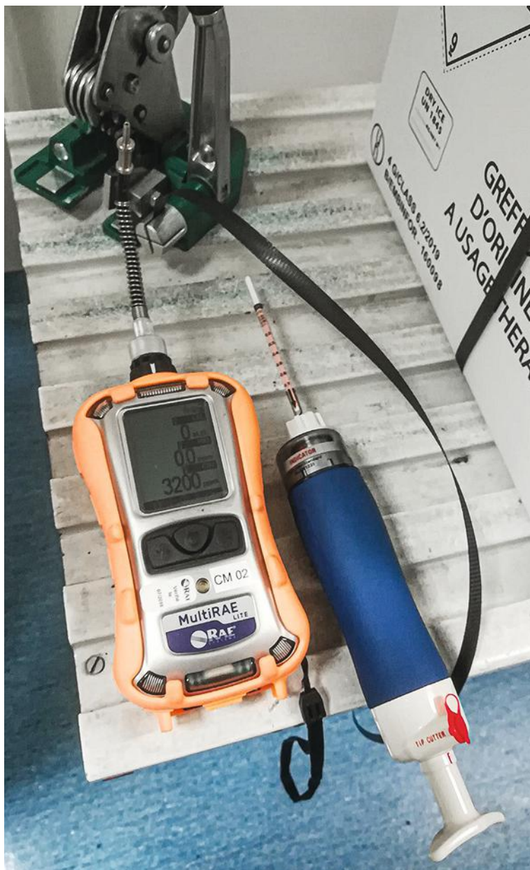
↑ FIGURE 9 Mesure de CO 2 par un tube colorimétrique associé à une seringue de prélèvement (appareil de droite) et par un DTR multigaz actif (appareil de gauche).
