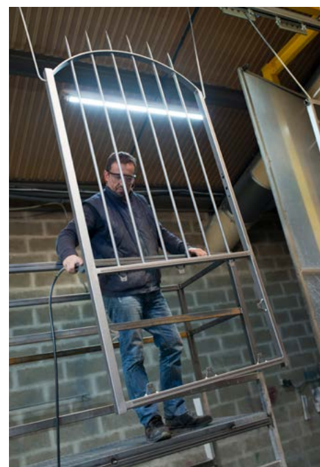
Une pièce sortant d'une cabine de grenailage
