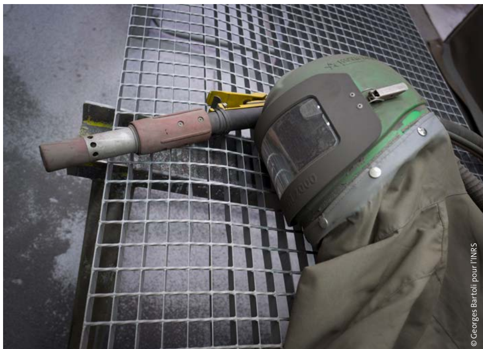
Système de projection d'abrasif, cagoule et combinaison de protection
