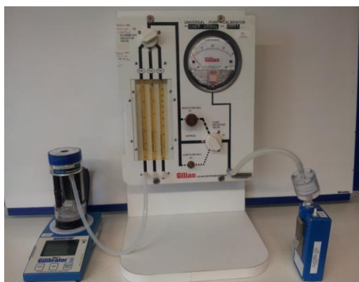
Figure 11 : montage pompe et calibreur
