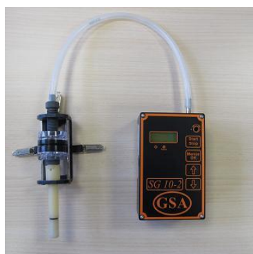
Figure 9 : cyclone relié à une pompe
