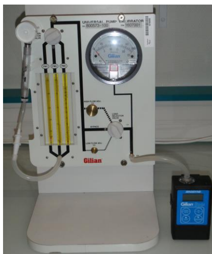
Figure 10 : montage pompe, calibreur puis dispositif
