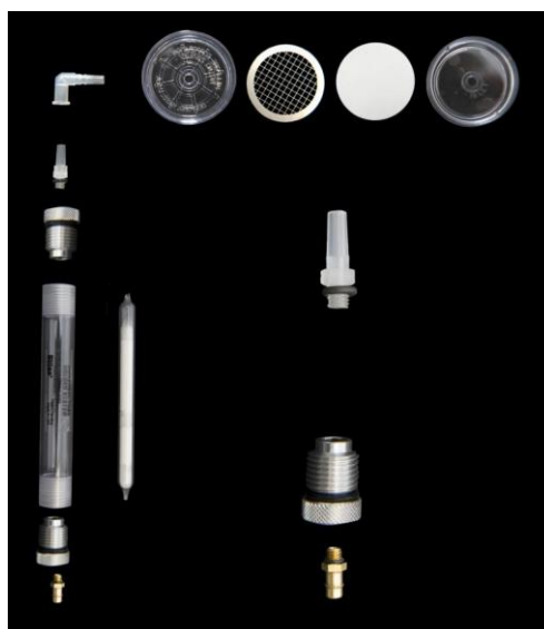
Figure 7 : Vue éclatée d'un exemple de dispositifs combinés
