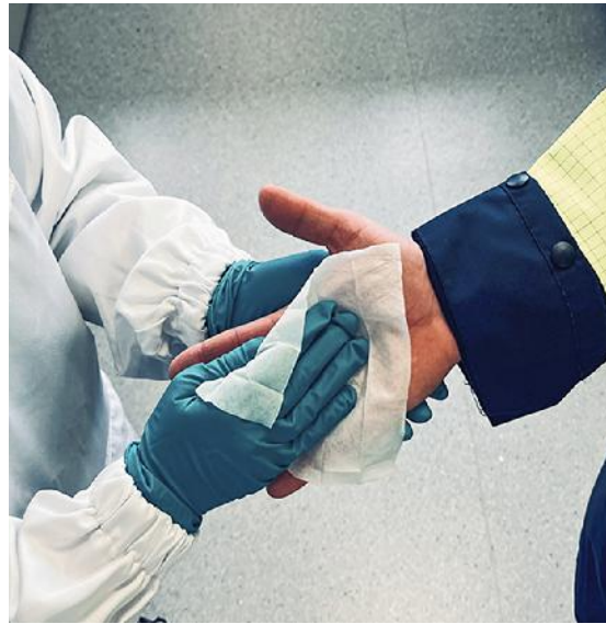
← FIGURE 7 Prélèvement de surface cutanée sur la main dominante d'un travailleur.
