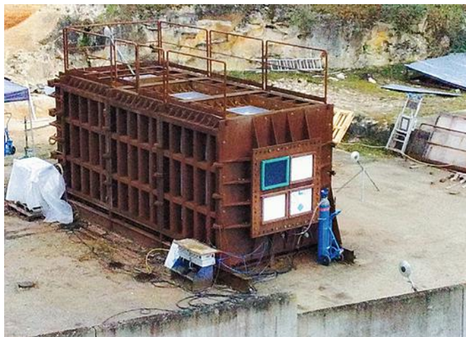
↑ FIGURE 4 Chambre d'explosion de 37,5 m 3 .
