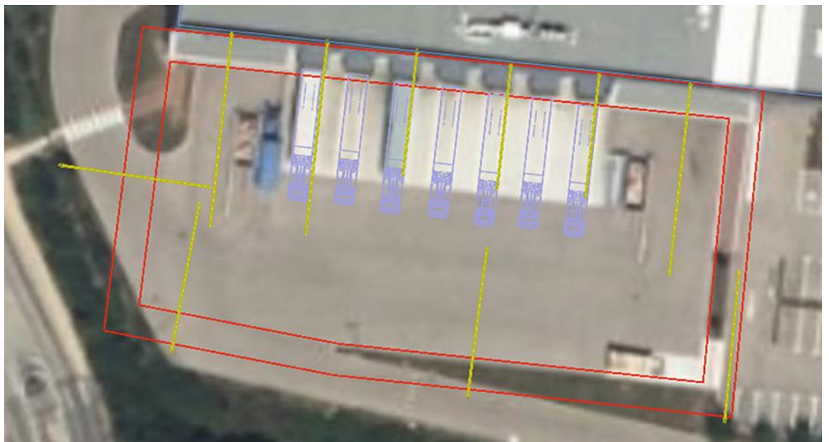
FIGURE 18 → Ajout de luminaires complémentaires (traits jaunes) pour éclairer la zone environnante (traits rouges) (logiciel utilisé : ReluxDesktop).
