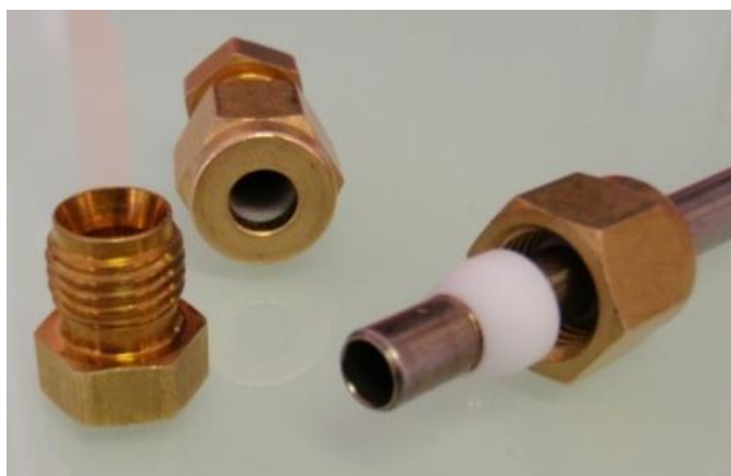
Figure 4 : Embout Swagelok® laiton et ferrule téflon
