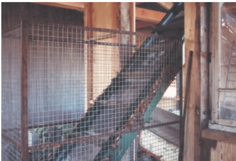
Fig. 12. Tapis d'évacuation des écorces avec protection grillagée - Bark conveyor with net protection
