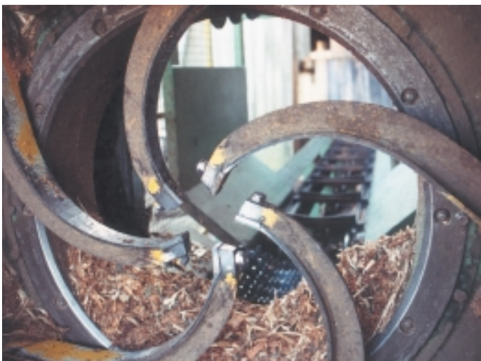
Fig. 6. Rotor à 5 outils racleurs à pastilles carbures fixées mécaniquement (Cliché Sté SEGEM) - Rotor with five mechanically fixed carbide tipped cutters
