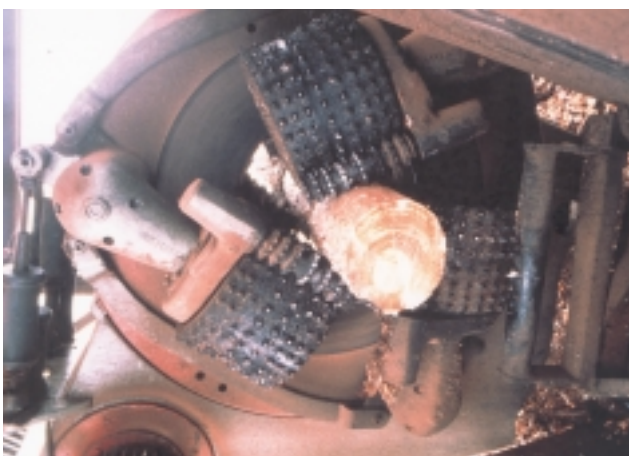
Fig. 7. Ecorceuse à rotor à axe fixe avec entraînement et centrage des bois par rouleaux à picots (Cliché Sté CIRIS) - Debarker with fixed-axis rotor and wood feeding and centring by feed rollers
