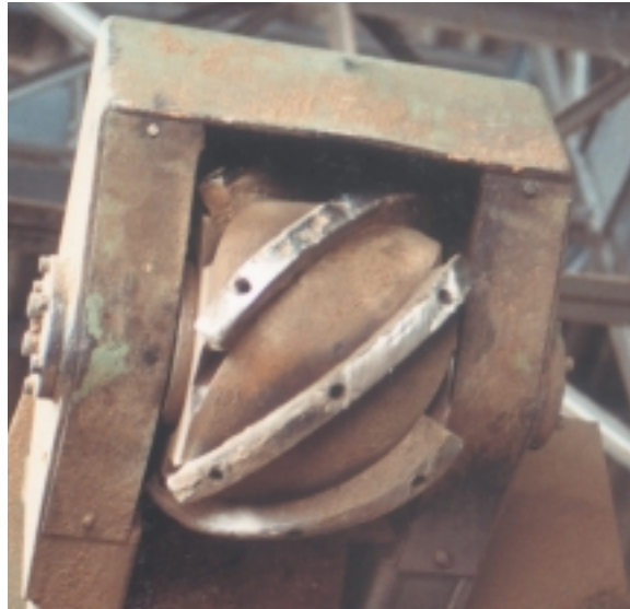
Fig. 2. Fraise à outils hélicoïdaux - Helical-toothed rosserhead
