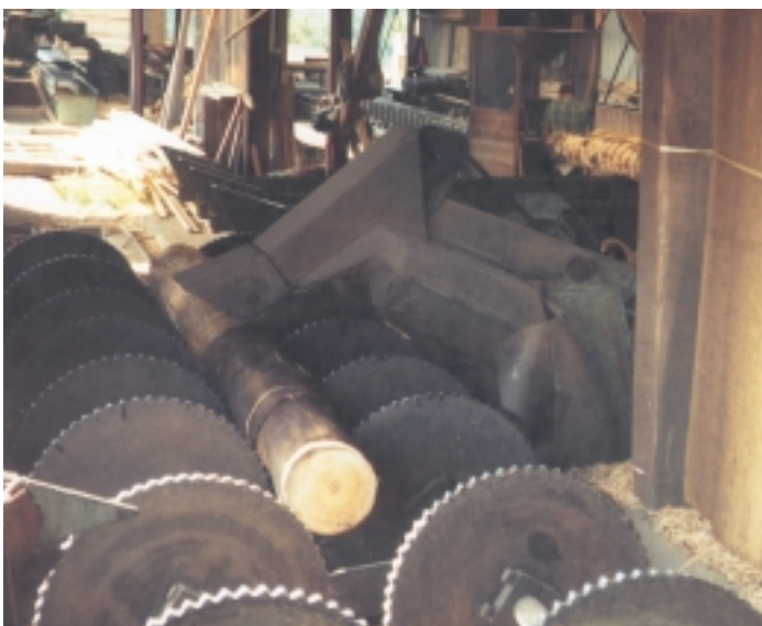
Fig. 4. Ecorceuse à fraise à charriot - Carriage-mounted rosserhead debarker
