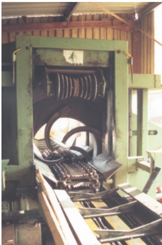
Fig. 8. Écorceuse à rotor mobile verticalement et entraînement des bois par chenille crantée et diablo (Cliché Sté ESTERER) - Debarker with vertically mobile rotor and wood feeding by bull wheel and buggy drive
