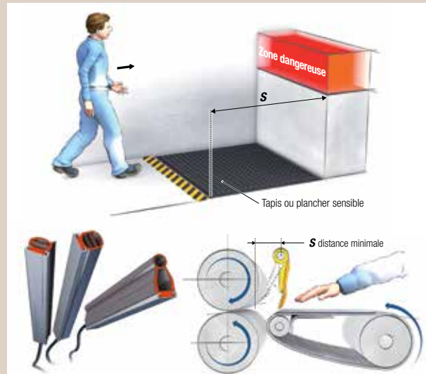
↑ FIGURE A: Dispositifs de protection sensibles à la pression.
