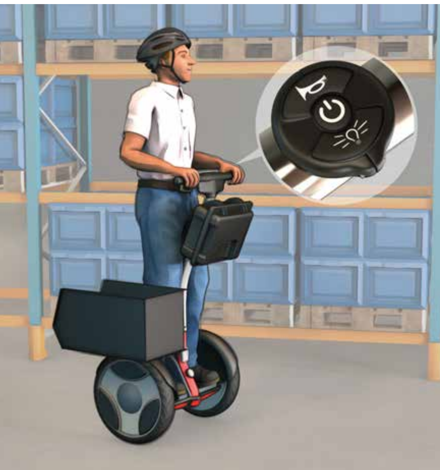
↑ FIGURE 2 Équipements pour un gyropode à usage professionnel.
