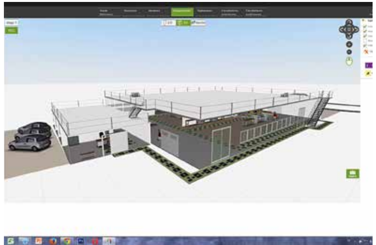
↑ FIGURE 5 Le bâtiment doit être conçu comme une partie active de l'espace de travail ; ici, accès à la lumière naturelle, protections en toiture, tracé des voies de circulation.
