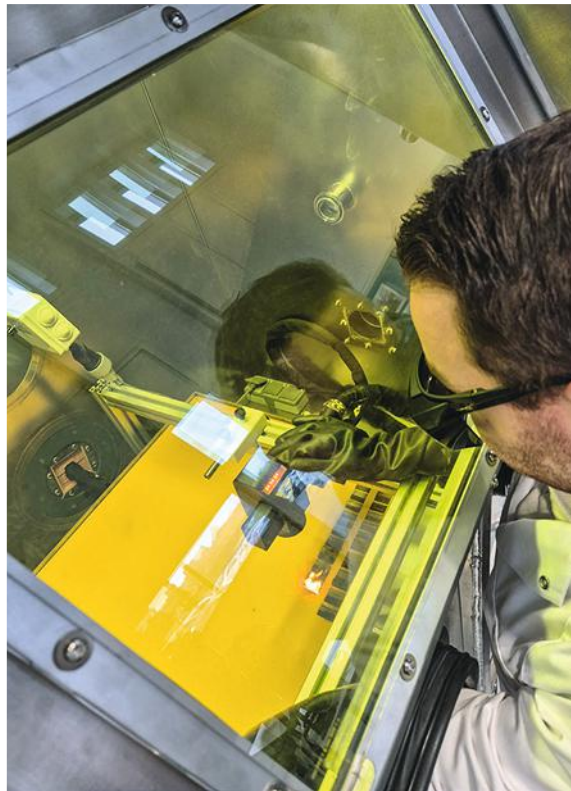
← FIGURE 1 Cabine d'essai utilisée pour la caractérisation des émissions lors du décapage laser manuel.
