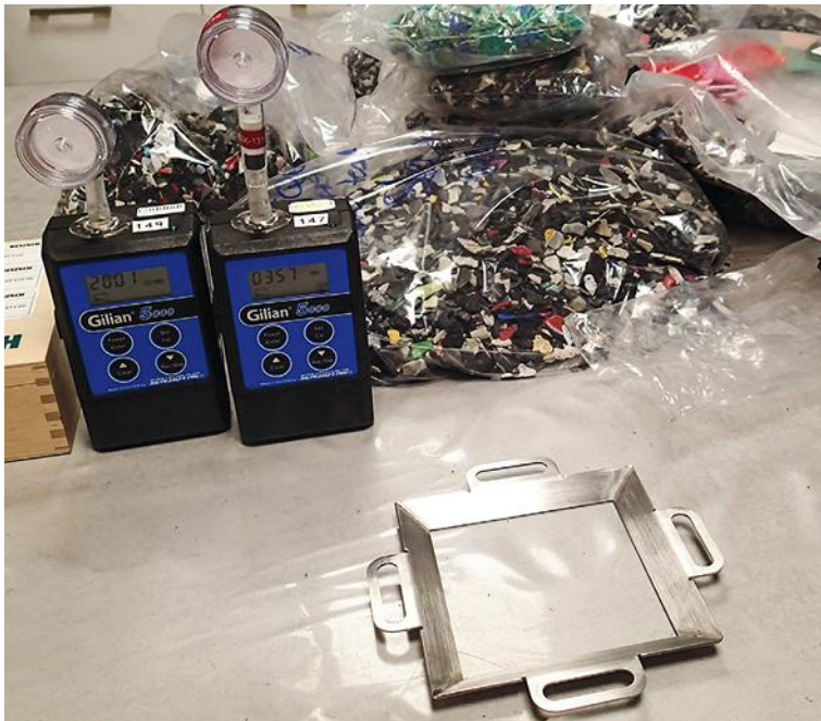
↑ FIGURE 5 Gabarit de prélèvement surfaccique couplé à un prélèvement atmosphérique dans un laboratoire in situ d'analyse des fractions plastiques.
