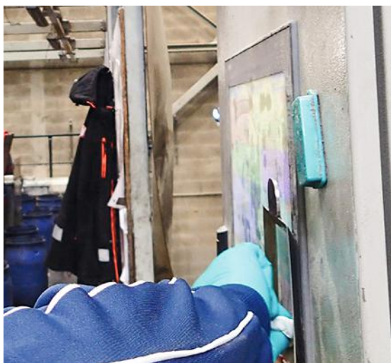
FIGURE 6 → Prélèvement surfaccique en cours sur un poste de contrôle.
