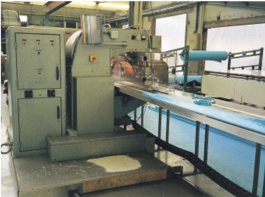
Fig. 2. Installation ISM 27 MHz (presse à souder le PVC) - 27 MHz PVC welding machine
