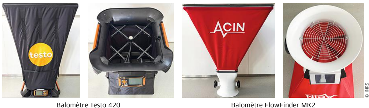
FIGURE 6 → Balomètres utilisés pour la mesure du débit.
