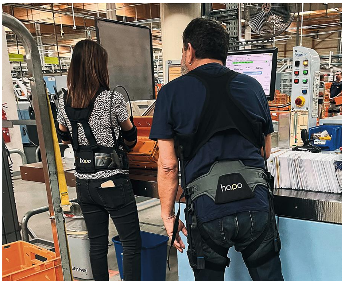
Deux testeurs volontaires sur une plateforme industrielle courrier (PIC): (à gauche) agente équipée d'un exosquelette d'assistance des membres supérieurs; (à droite) agent équipé d'un exosquelette d'assistance dorso-lombaire.
