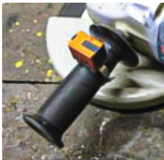
←FIGURE 3 Fixation d'un dosimètre pour la mesure de l'exposition aux vibrations transmises aux membres supérieurs.
