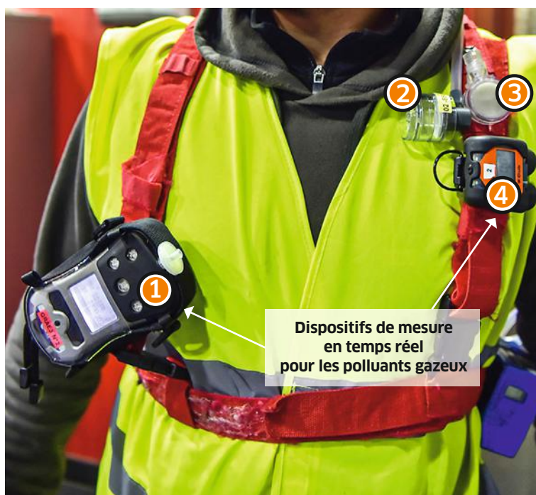
↑ FIGURE 1 Travailleur équipé de dispositifs de prélèvement pour analyse en différé (en haut à droite) et d'instruments de mesure en temps réel (dont un détecteur passif à photo-ionisation (PID) pour la mesure des composés organiques volatils (en haut à droite) et un détecteur multigaz (en bas à gauche) comportant un capteur électrochimique d'ammoniac). 1. Détecteur multigaz (ammoniac) 2 et 3. Dispositifs de mesure en différé pour les polluants particulaires et gazeux 4. Détecteur PID (COV)
