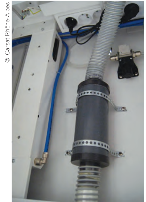
Photo 6. Le silencieux de la cheville ventilée disposé sous l'établi
