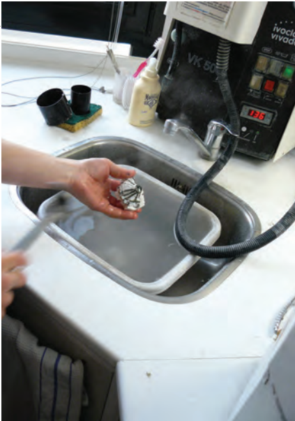
Photo 3. Casse du cylindre à l'humide
