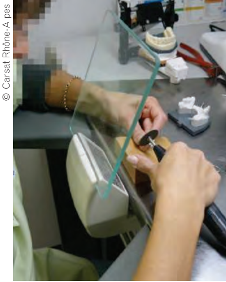
Photo 1. La cheville ventilée munie d'un écran intégré
