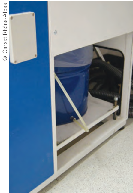
Photo 5. Le bac de récupération des poussières
