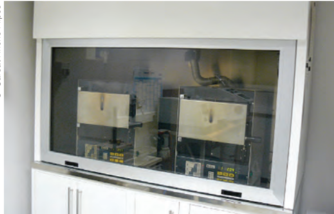
Photo 8. Fours disposés dans une sorbonne de laboratoire munie d'une aspiration par le haut
