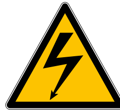
■ Figure n°2 : Le pictogramme de danger «Électricité».
