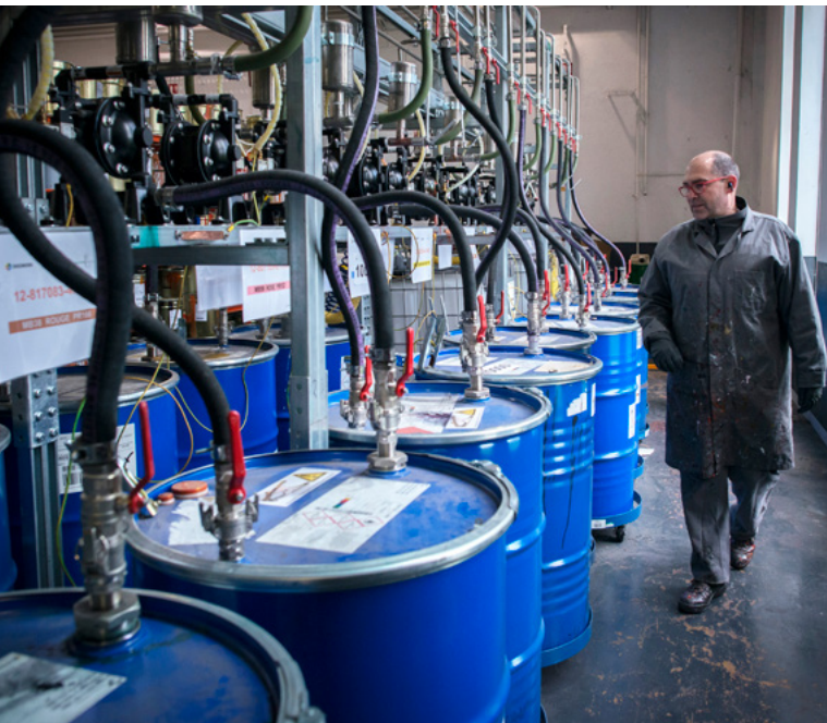
■ Figure 3 : Station de dosage de solvant avec pompes pneumatiques (système clos automatisé)
