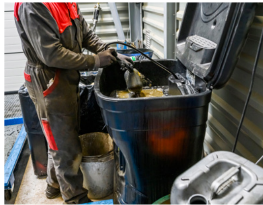
■ Figure 2 : Fontaine de dégraissage sans solvant
