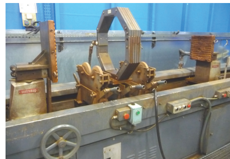
Figure 2. Inducteur sur banc de magnétoscopie
