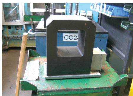
Figure 3. Démagnétisation des pièces tenues à la main
