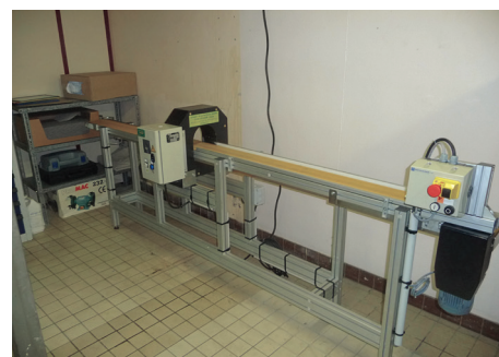
Figure 4. Démagnétisation des pièces sur convoyeur
