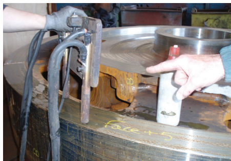
Figure 1. Magnétisation transversale avec un inducteur portatif
