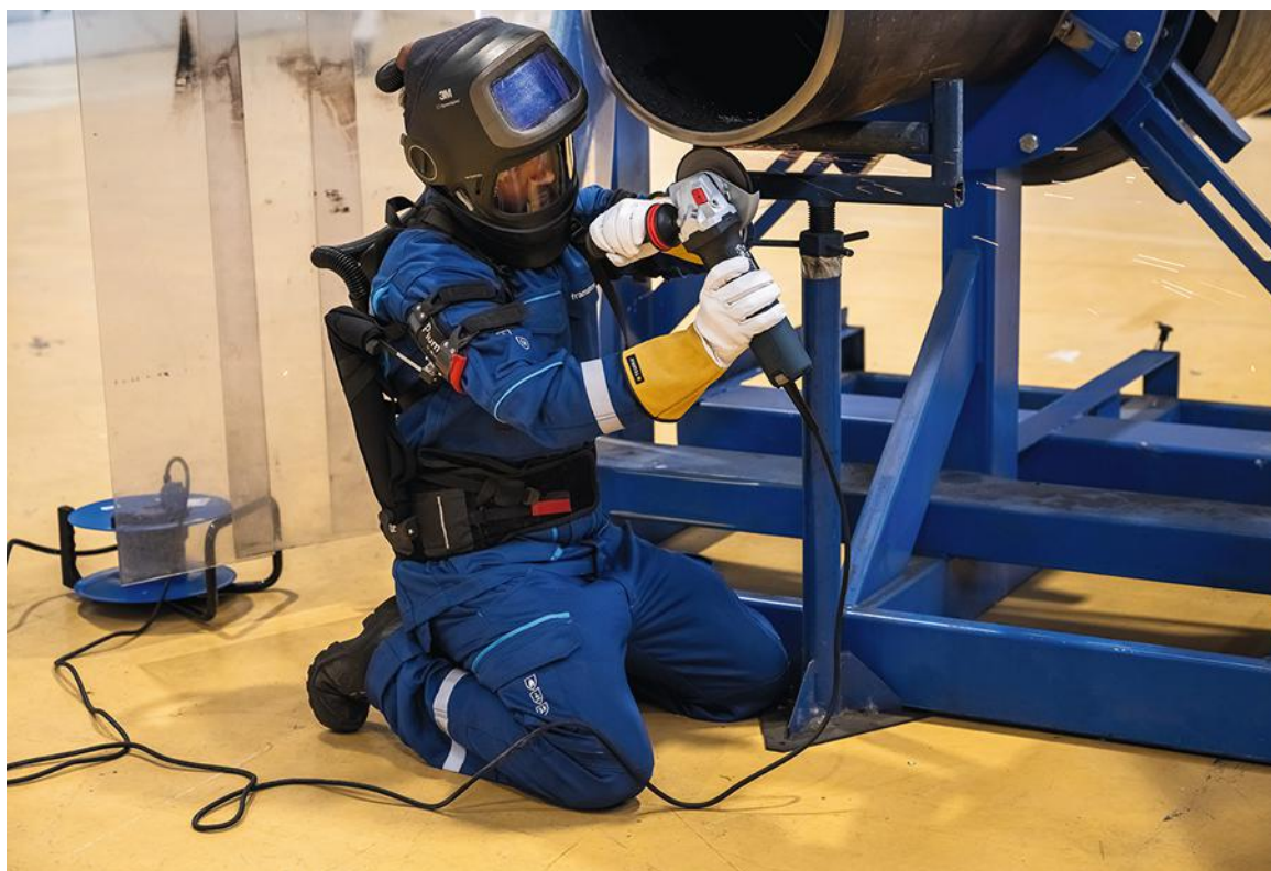
Soudeur équipé d'un exosquelette pour réaliser une opération de meulage.
