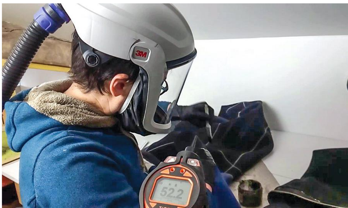
FIGURE 6 → Opération d'encollage au pinceau. L'appareil au premier plan est un PID affichant une concentration de COV en équivalent isobutène supérieure à 50 ppm v .
