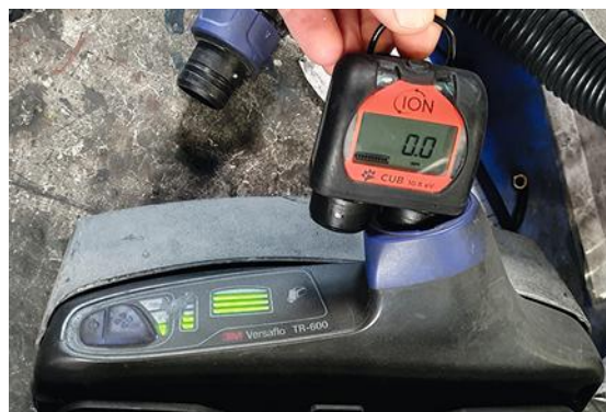
← FIGURE 3 Mesure en sortie du bloc de ventilation de l'APR équipée d'une cartouche A2P neuve. Le PID indique 0,0 ppm v , preuve qu'aucune vapeur organique n'est relarguée par la cartouche. Étape 3 du protocole Petesaf, cas d'une cartouche fonctionnelle, non saturée.
