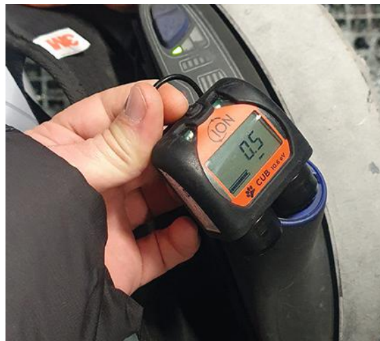
← FIGURE 4 Mesure en sortie de bloc de ventilation de l'APR. Le PID indique la détection de vapeurs organiques en sortie de cartouche. Étape 3 du protocole Petesaf, cas d'une cartouche non fonctionnelle, saturée.
