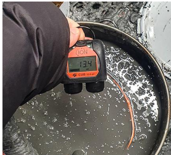
← FIGURE 2 Vérification de la réponse du PID aux polluants volatils en plaçant l'appareil juste au-dessus de la source (seau de peinture). Étape 2 du protocole Petesaf.
