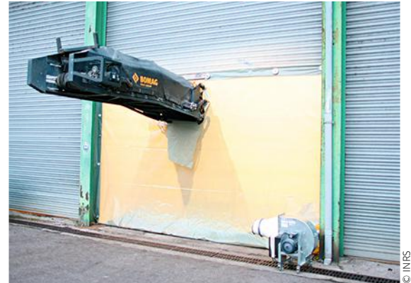
↑ FIGURE 3 Séparation intérieur/extérieur pour le test de mesure de l'efficacité de captage.
