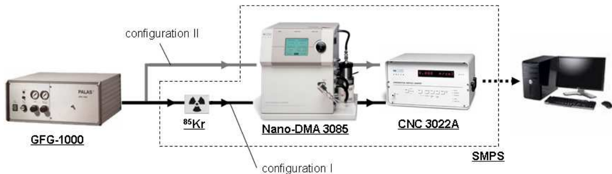
Figure II-17 : Montage utilisé pour la caractérisation des aérosols générés par le GFG-1000
