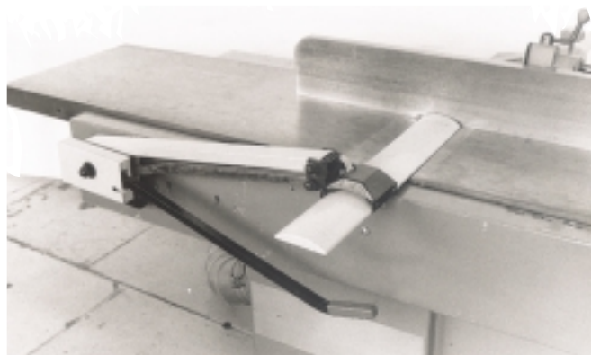
Fig. 10. Protecteur Saintonge (Ets MORI) (existe en 3 longueurs de bras : 750, 810, 950 mm)
