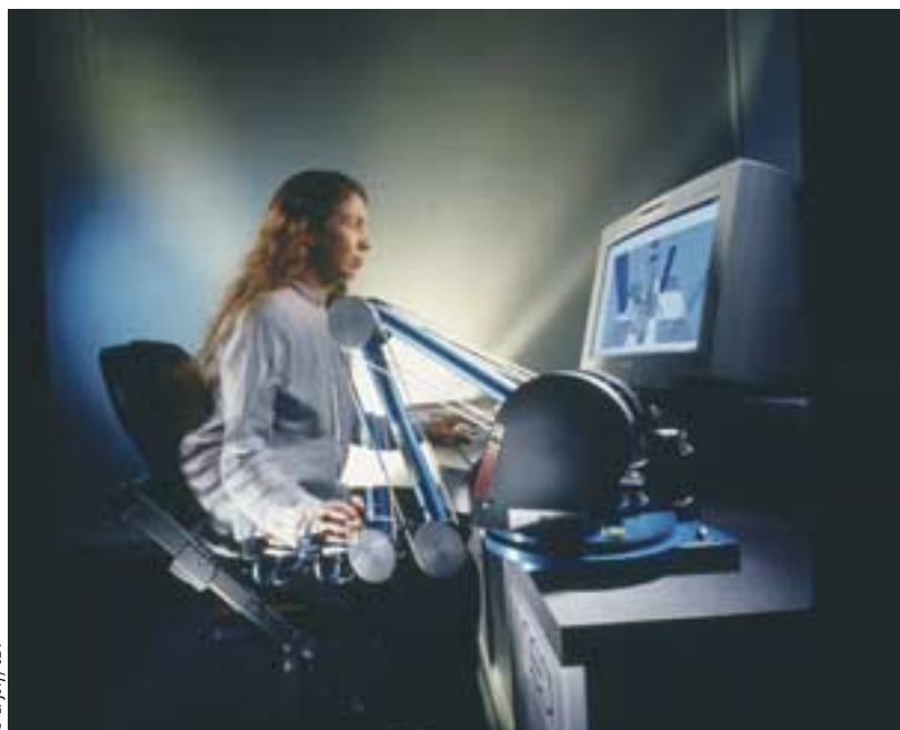
Figure 14. Télémanipulation d'un robot assisté par ordinateur (bras à retour d'effort)
