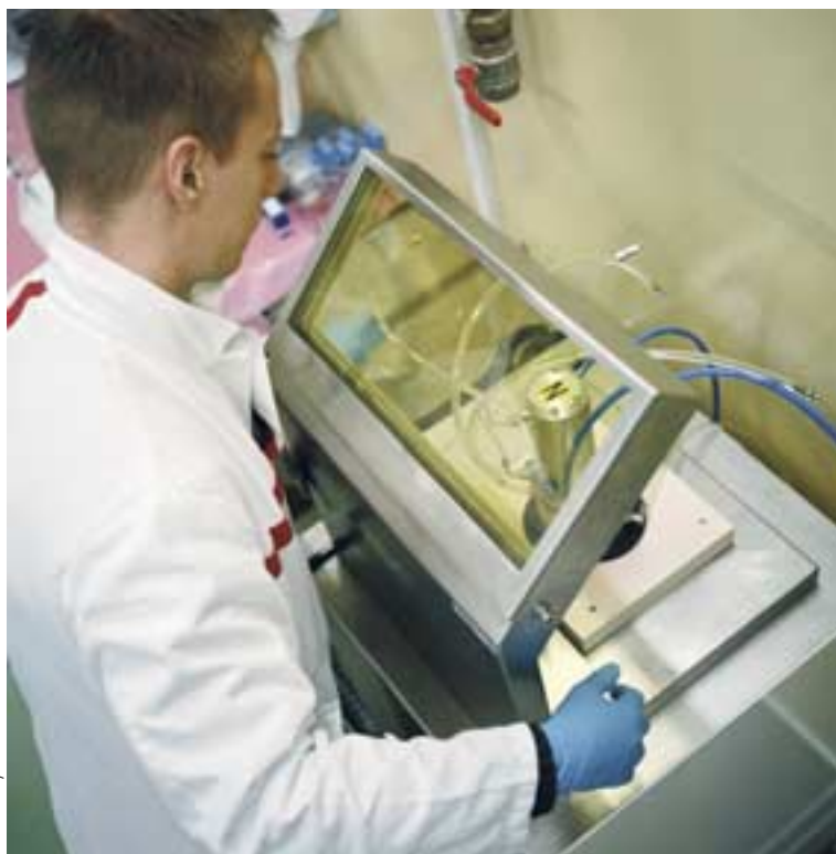
Figure 10. Mise en œuvre d'un écran de protection
