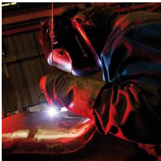
Figure 10. Opération de soudage à l'arc avec électrodes enrobées
