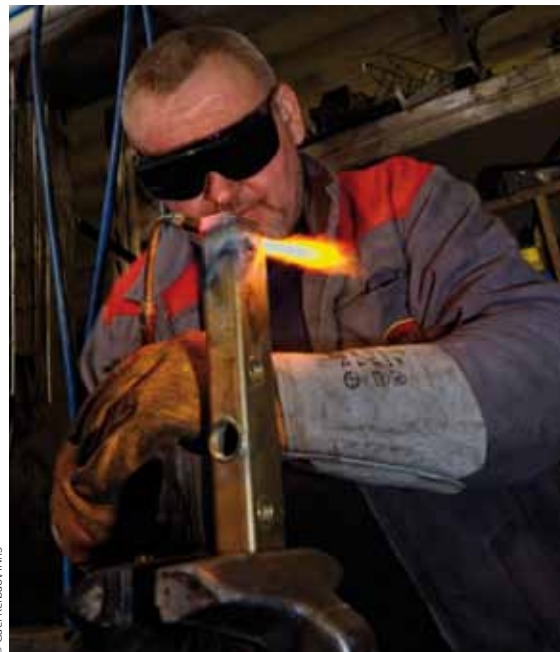
Figure 9. Opération de soudage à la flamme
