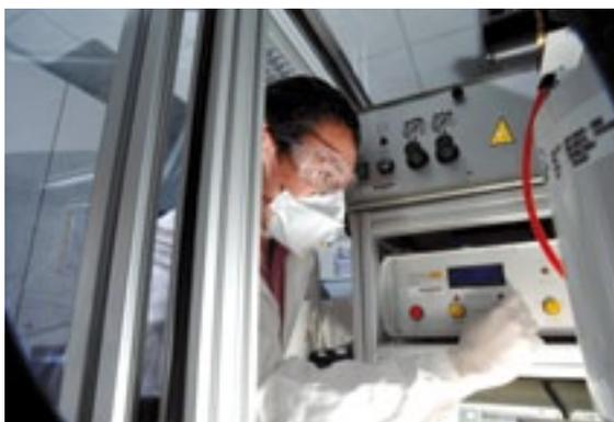
► Réglage de l'installation Caiman de l'INRS pour la génération d'aérosols de nanoparticules métalliques.
