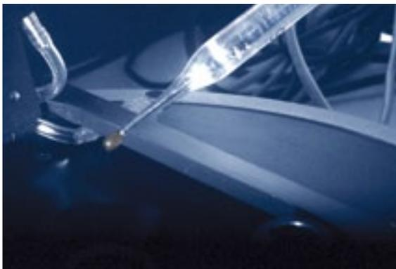
► Dépôt d'une goutte d'une suspension de nanoparticules pour analyse granulométrique par diffusion dynamique de la lumière (DLS).
