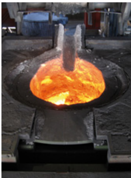
Figure 1. Four à induction utilisé en fonderie pour réaliser les alliages ferreux (acier, fonte).
