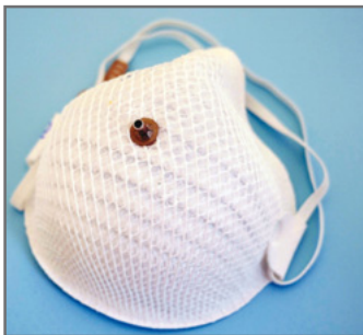
Figure 4 : Adaptation d'un demi-masque filtrant pour la réalisation d'un essai
