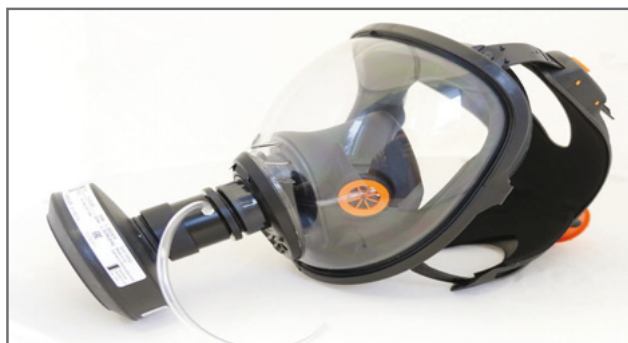
Figure 5 : Adaptation d'un masque complet pour la réalisation d'un essai d'ajustement quantitatif par comptage de particules
