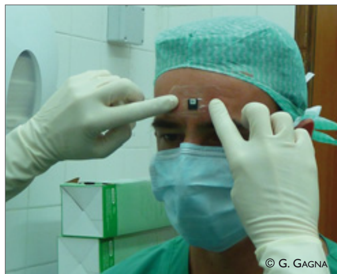
Photo 1 : Fixation d'un dosimètre nanoDot® fixé sur le front au moyen d'un film collant transparent.
