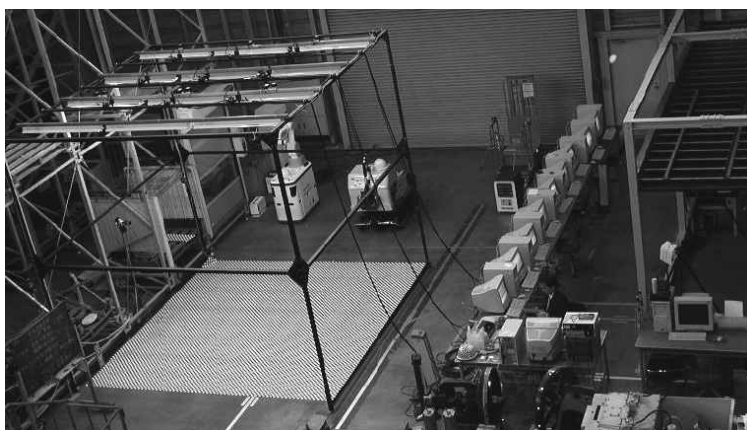
Figure 3 : système développé par le JMF basé sur l'utilisation d'une mire de référence
