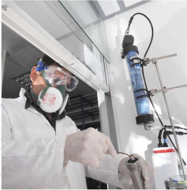
Préparation d'un essai sur l'émission d'aérosol d'une nanopoudre dans l'installation Nanoduster.
