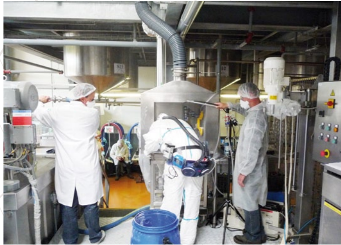
Illustration d'une action de caractérisation de l'exposition d'un opérateur à une station de vidange de sacs de nanomatériaux en poudre.
