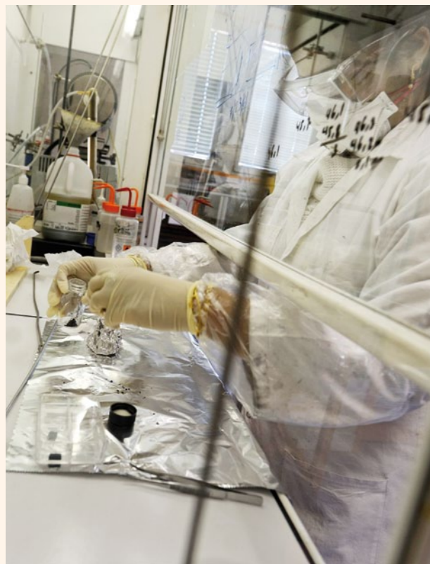
Opérations de synthèse et de collecte de nanotubes de carbone sous une sorbonne.
