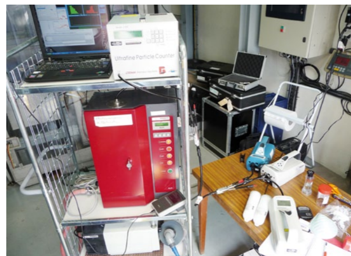
Exemple d'instruments de mesure en temps réel utilisés pour caractériser les émissions et expositions aux aérosols de nanoparticules en environnement de travail.
