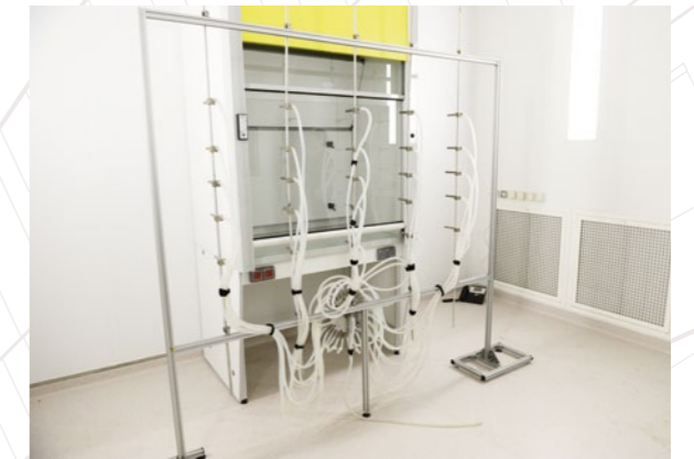
Essai de confinement d'une sorbonne en salle propre.
