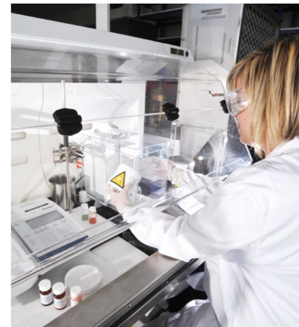
Pesée d'un échantillon de nanopoudre en condition sécurisée, sous enceinte ventilée spécifique.
