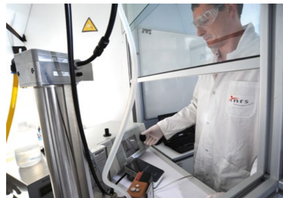
Réglage de l'installation Caiman pour la génération d'aérosols de nanoparticules métalliques.
